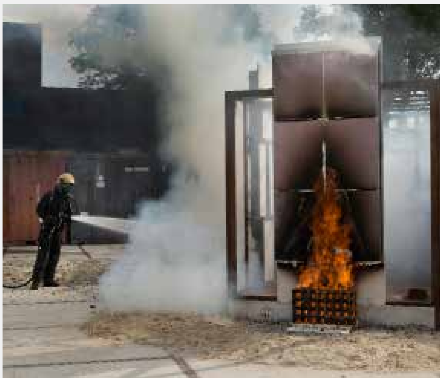
Tijdens het Fire Seminar vond een demonstratie plaats met op het oog twee vergelijkbare gevels, maar met een totaal ander brandgedrag.
