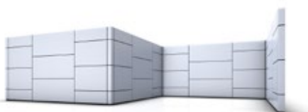
5. Vertikální asymetrická instalace
