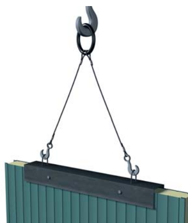
4.12.6. ábra: függőleges AWP, AWP Flex falpanel mozgatása a rövid élen U-profillal és két átmenő csavar segítségével megfogva
