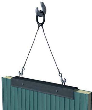
4.13.8. ábra: függőleges FH/LH (< 7 000 mm) panel mozgatása a rövid élen U-profillal és két átmenő csavar segítségével megfogva
