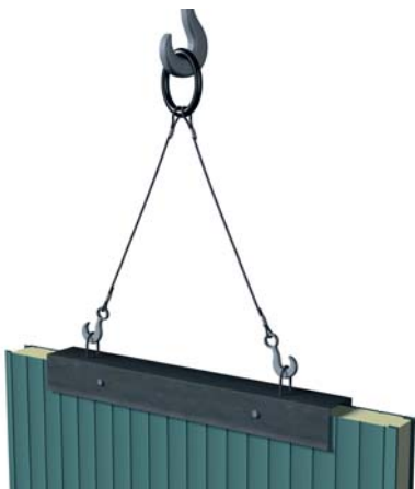
4.11.4. ábra: függőleges TF, TC (FR < 7 000 mm) panel mozgatása a rövid élen U-profillal és két átmenő csavar segítségével megfogva
