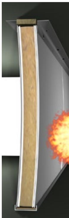
Figur 15. Paroc Panel System-elementenes forløp ved brann.
