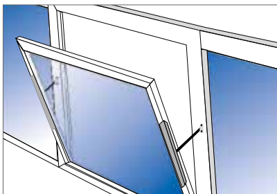
Kippfenster oben einwärts mit Kettenantrieben als Zugbrücke
