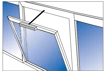
Kippfenster oben einwärts mit Kettenantrieb
