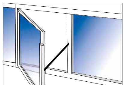
Drehfenster einwärts mit Kettenantrieb
