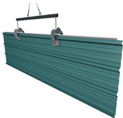
obr. 4.4.6: manipulace se střešním panelem pomocí montážní přípravku („kleština“ – pro uchycení panelu za pevnou vlnu)
