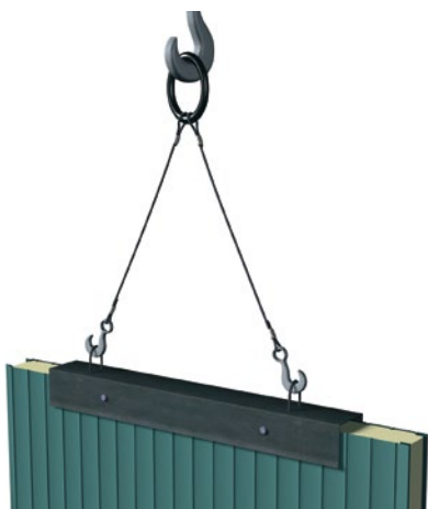
obr. 4.11.4: manipulace s panelem TF, TC (FR < 7 000 mm) při svislém kladení panelů („U-nosič“ – upevněný pomocí dvou kolíků)
