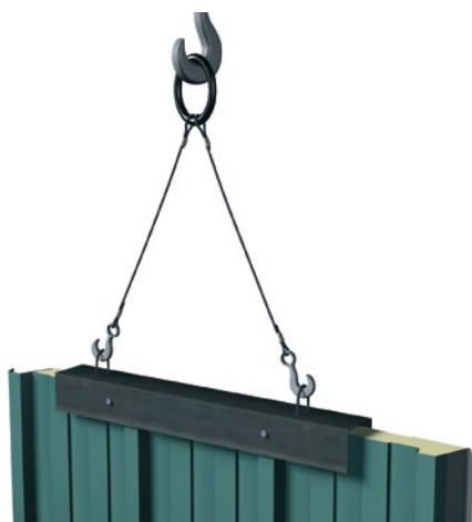
obr. 4.14.4: manipulace se stěnovým panelem RW při svislém kladení panelů. („U-nosič“ – upevněný pomocí dvou kolíků)
