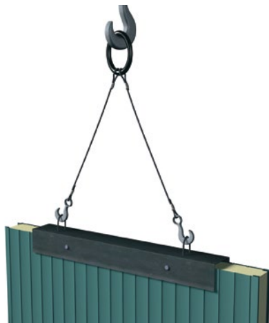
obr. 4.13.8: manipulace s panelem FH (LH) < 7 000 mm při svislém kladení panelů („U-nosič“ – upevněný pomocí dvou kolíků)
