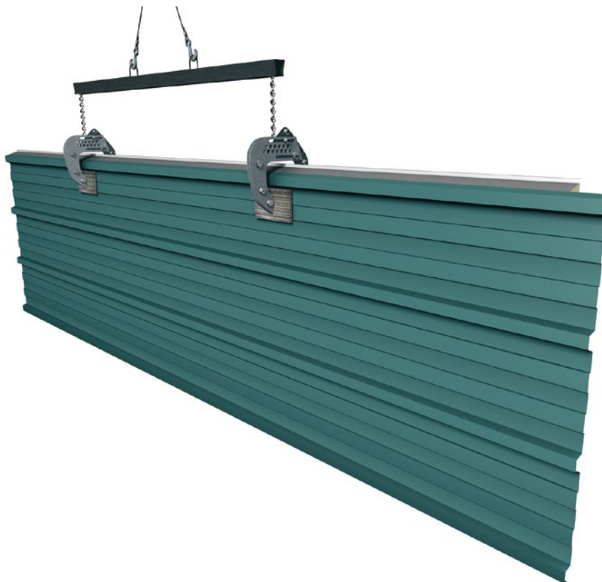
obr. 4.14.3: manipulace se stěnovým panelem RW při vodorovném kladení („kleština“ – pro uchycení panelu za pevnou vlnu)
