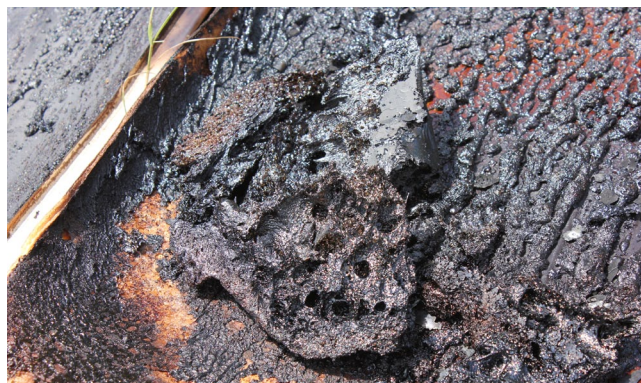
A PUR B3 TELJESEN MEGOLVADT, FOLYT – AHOL LÁNGHATÁST KAPOTT, OTT AZ ANYAG MEGSEMMISÜLT
