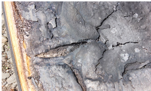
PIR: SZENESEDÉS ÉS REPEDEZÉS AZ ERŐSEBB, BARNULÁS A GYENGÉBB LÁNGHATÁSNÁL
