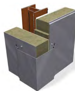
Figur 3. Linjär värmeigenomgång ( \Psi -value) för några vanliga detaljlösningar.
